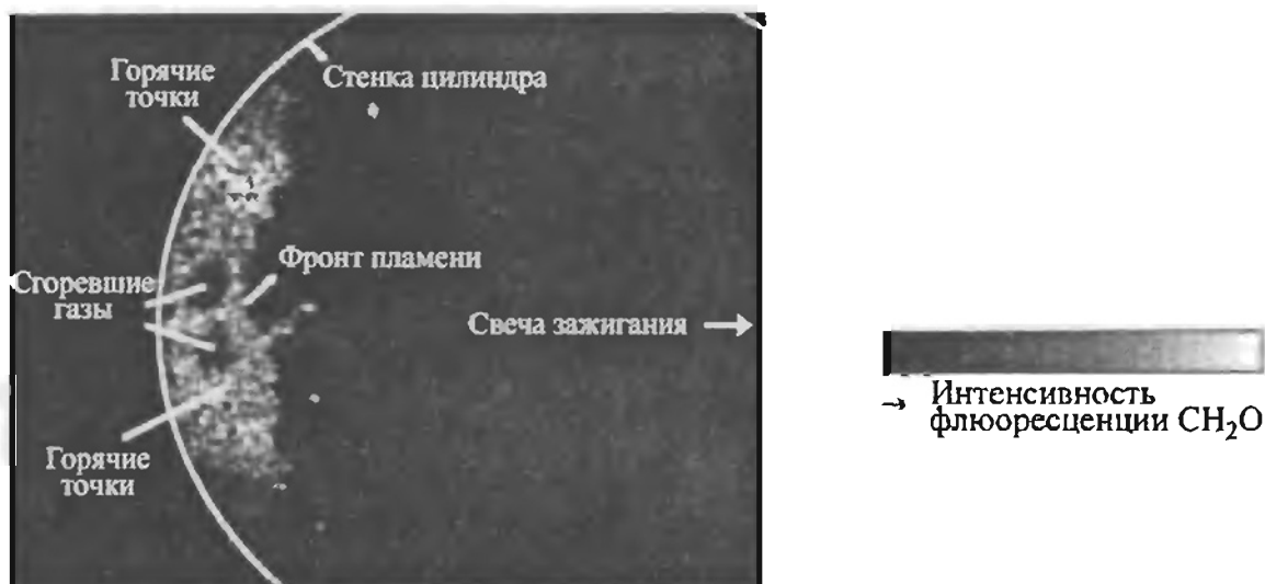
Рис. 16.10. Образование горячих точек в отходящем газе в двигателе внутреннего сгорания (двигателе Отто) (визуализация \text{CH}_2\text{O} при помощи 2D ЛИФ-методики)
