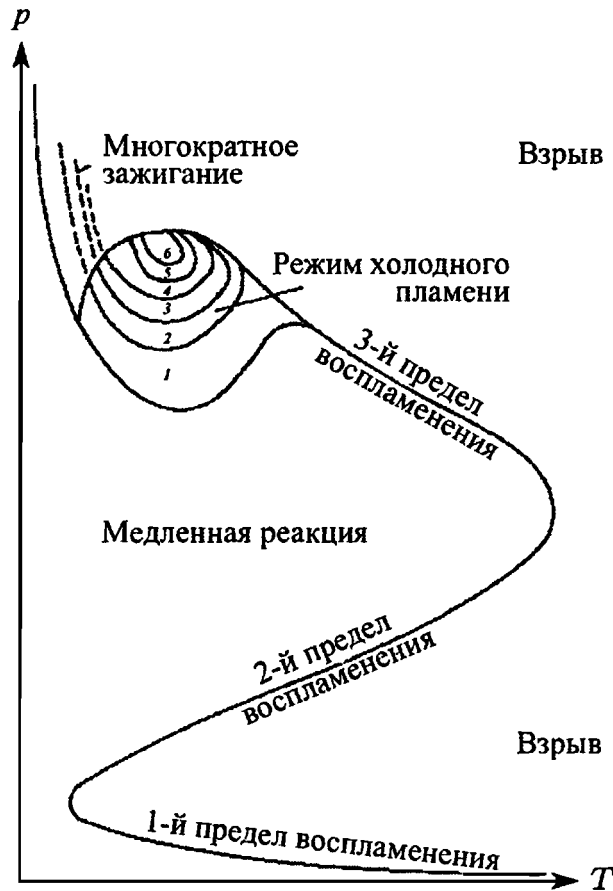
Рис. 10.4. Пределы воспламенения ( (p-T) -диаграмма пределов воспламенения) для углеводородов (схематическое представление) [Warnatz, 1981c]
