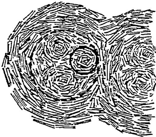
Рис. 18.11. Простая модель коагуляции частиц сажи [Ishiguro et al., 1997]
