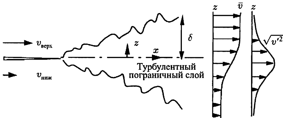
Рис. 12.6. Схематическая иллюстрация турбулентного слоя с градиентом скорости
